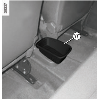
محفظه متحرک کنسول مرکزی عقب ۱۳ برروی محفظه کنسول مرکزی عقب ۱۲ نصب می‌شود.
