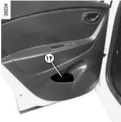
محفظه نگهداری اشیاء کوچک در درب عقب ۱۴ امکان قرار دادن یک بطری ۰.۵ لیتری در آن وجود دارد.
