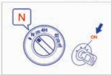
خودروهای مجهز به سوچیج انتقال ممکن است از ناحیه جلو و در حالیکه هر چهار چرخ بر روی زمین قرار دارد، بکسل شوند. اطمینان حاصل نمایید که از تجهیزات بکسل مناسب که برای این نوع بکسل طراحی شده اند استفاده می‌شود و اطمینان حاصل نمایید که سرعت خودرو در حین بکسل از ۹۰ km/h (55 mph) تجاوز نمی‌نماید.
