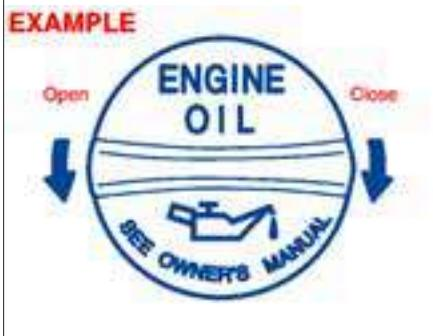
در بخش روغن را بردارید و به آرامی از میان سوراخ روغن، تا رسیدن به حد بالاتری روغن روی گیج، روغن اضافه نمایید. دقت نمایید که بیش از اندازه روغن اضافه نکنید. روغن بیش از حد، تقریباً به اندازه کمبود روغن ضرر می باشد. پس از پر کردن روغن، موتور را روش نموده و اجزا دهید یک دقیقه دردور آرام کار کند. موتور را خاموش نمایید و ۵ دقیقه صبر کنید و مجدداً سطح روغن را کنترل نمایید.
