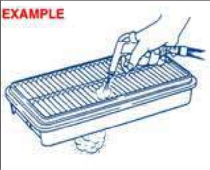
اگر فیلتر هوای گرد و غبار مسدود شده باشد مقاومت بیشتری در برابر هوای ورودی بوجود می آید که منجر به کاهش توان خروجی و افزایش مصرف سوخت می گردد.
