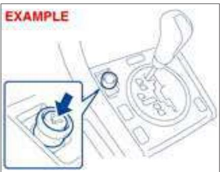
فندک در هنگامی که سوئیچ در وضعیت "ACC" یا "ON" قرار دارد کار می‌کند.
