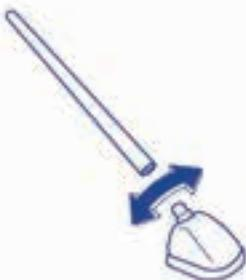
آنلن رادیو قابل برداشتن می‌باشد به منظور بازگردان آنلن آن را در خلاف جهت عقربه های ساعت پیچیده خاند. جهت نصب مجدد آنلن آن را بوسیله دست درجهت عقربه های ساعت محکم بیجید.
