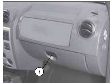
۱- جعبه داشبورد برای باز کردن جعبه داشبورد، دستگیره ۱ را بکشید. در داخل آن، دو قسمت جهت قرار دادن مداد و کارت و... تعبیه شده است.
