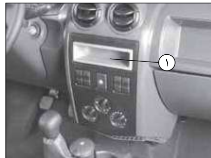
۱ محل نصب سیستم صوتی درپوش را بردارید. اتصالات آنتن، تغذیه + و -، سیم‌های بلندگو چپ و راست در پشت آن قرار دارند.
