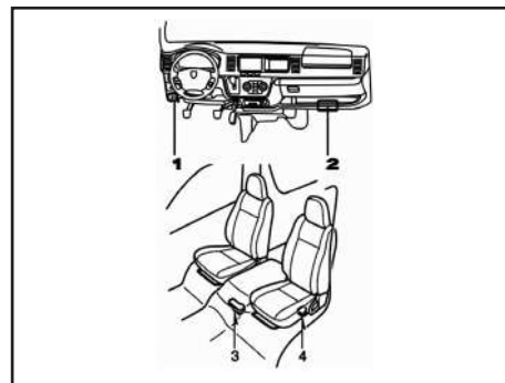
محل نصب جعبه فیوزها خودروه‌های چپ فرمان
