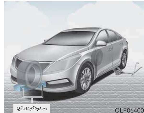
. ۵ جلو و عقب تایری که به صورت قطری در جهت تاثیر تعویضی قرار دارد را مانع قرار دهید.
