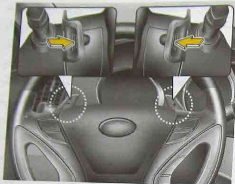
پدال تعویض دنده (در صورت مجهز بودن) وستی دسته دنده در موقعیت D یا اسپرت قرار دارد، می توان از پدال تعویض دنده استفاده کرد.
