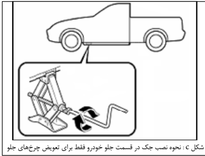
شکل C: نحوه نصب جک در قسمت جلو خودرو فقط برای تعویض چرخ‌های جلو
