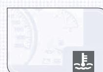
▪ نشانگر دمای آب / سطح آب اگر با روشن بودن موتور و حرکت خودرو این چراغ خاموش نمی‌شود یا هنوز چشمک می‌زند نشان‌دهنده این است که دمای آب خلیل بالاست و یا سطح آب پایین است. در این صورت وضعیت بلاقاصله خودرو را متوقف کنید و سطح آب را چک نمایید و در صورت لزوم آن را پر کنید.
