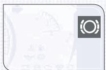
اگر بعد از باز کردن سوپریج یا در حین رانندگی این چراغ روشن شده یا چشمک می‌زند، نشان‌دهنده این است که لنت ترمز تا حد نهایی ساییده شده و اتصال داخلی لنت ترمز قطع شده است.
