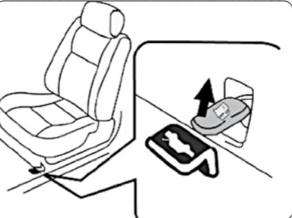
۱. اهرم داخلی تنظیم درپوش باک سوخت را بالا کشیده آن را باز نمایید.
