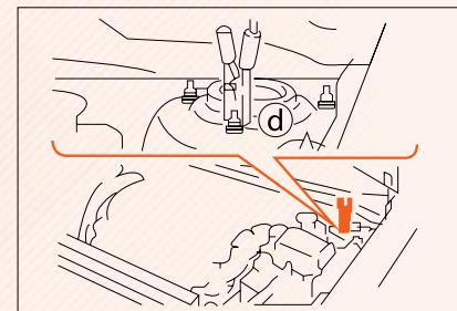
از اتصال کابل کمکی به بخش های متحرک موتور خودداری نمایید.
