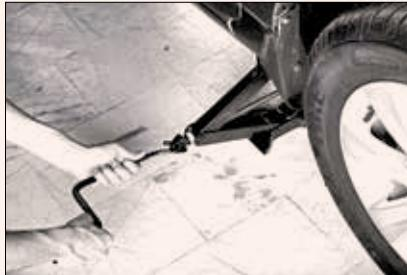
پیش از نصب چرخ‌ها تمامی زنگرزدگی‌ها را با بررس سیمی تمیز نمایید. تماس نادرست بین سطوح فلزی موقع نصب، ممکن است منجر به شل شدن مهره‌های چرخ و در نتیجه خارج شدن چرخ هنگام رانندگی شود.
