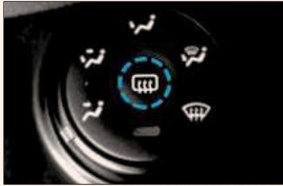
سوئیچ باید در موقعیت روشن "ON" قرار داشته باشد. سیم‌های داخل شیشه عقب به سرعت سطح شیشه عقب را تمیز می‌کنند. چراغ نشانگر گرمکن روشن شده، فعال بودن گرمکن را نشان می‌دهد. با فشار مجدد کلید، گرمکن خاموش می‌شود. ۱۵ دقیقه پس از روشن کردن، گرمکن به طور اتوماتیک خاموش می‌شود.
