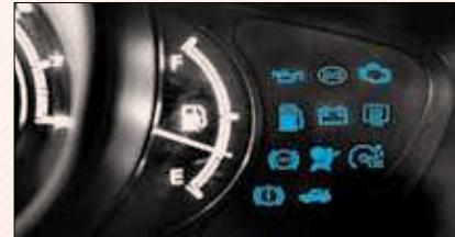
زمانی که سوئیچ در وضعیت روشن "ON" قرار دارد، چراغ هشدار "SRS" روشن شده و پس از حدود ٥ ثانیه خاموش می شود که بیانگر فعالیت صحیح سیستم پیش کشنده کمربندهای ایمنی جلو می باشد. سیستم چراغ هشدار برای کنترل "ECU" ایربگ، مجموعه کمربند ایمنی پیش کشنده، سیستم شارژ کار، چراغ هشدار، اتصالات و منع انرژی سیستم می باشد.
