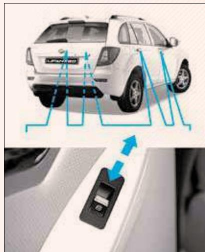
سپس هنگام پایین رفتن شیشه، از کلید برای بالا آوردن استفاده نمایید، شیشه متوقف می شود.
