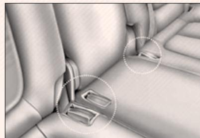
کمربند ایمنی عقب وسط، دارای دو نقطه اتکاء یا سه نقطه اتکاء با دو نقطه قفل نمودن می‌باشد.
