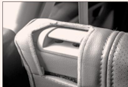
۴. مجموعه کلید تنظیم زاویه را به جهت بالا کشیده و پشتی صندلی را به سمت جلو بلند کنید. پس از تا شدن پشتی صندلی، مجموعه کلید را رها کنید.
