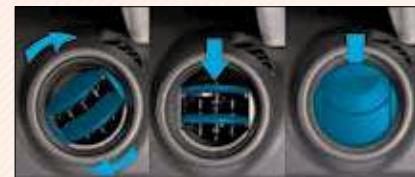
دریچه های جانبی را می توان مطابق تصویر باز و بسته نمود. در صورتی که میزان هوای خروجی در حد مناسبی نیست، دریچه های جانبی را کنترل نمایید.
