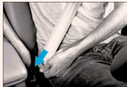
برای آزاد نمودن کمربند ایمنی، دکمه ضامن روی قفل را فشار دهید؛ کمربند ایمنی به طور اتوماتیک جمع می‌شود. در صورتی که کمربند ایمنی به سختی جمع می‌شود، کل تسمه را بیرون کشیده، عدم وجود پیچ یا گره را کنترل نمایید.
