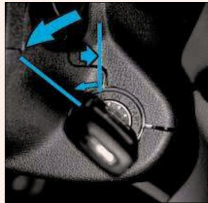
استارت "START": سوئیچ را به وضعیت استارت "START" بچرخانید. موتور استارت می‌خورد، با رها کردن، سوئیچ به وضعیت روشن "ON" بازمی‌گردد.
