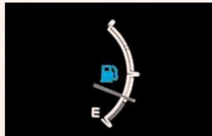
هنگام قرار داشتن سوئیچ خودرو در وضعیت روشن "ON" این درجه میزان سوخت درون مخزن را نمایش می‌دهد.
