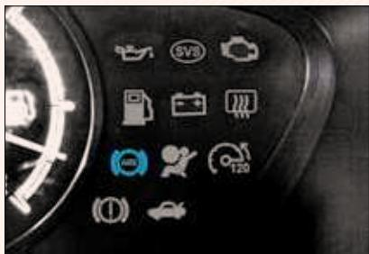
در صورت قرار داشتن سوئیچ خودرو در وضعیت روشن "ON" این چراغ هشدار روشن می‌شود. در صورت فعالیت عادی سیستم
