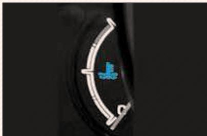
هنگام قرار داشتن سوئیچ خودرو در وضعیت روشن "ON"，این درجه دمای مایع خنک کننده موتور را نشان می‌دهد.
