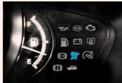
سیستم ایربگ بدون نیاز به تعمیر می باشد. چراغ نشانگر ایربگ بر روی صفحه کیلوومتر بیانگر فعالیت عادی سیستم ایربگ می باشد. هنگام استارت زدن خودرو چراغ نشانگر ایربگ به مدت ۶ تا ۸ ثانیه روشن شده و سپس خاموش می شود که نشانگر فعالیت عادی سیستم می باشد. بروز حالات زیر هنگام استارت زدن خودرو بیانگر فعالیت غیرعادی سیستم است:
