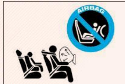
صندلی کودک رو به عقب را فقط در صندلی‌های عقب نصب کنید. در صورت نصب صندلی کودک رو به عقب بر روی صندلی سرنشین جلو، ایربگ با نیروی شدیدی باز شده، به شدت به صندلی ضربه زده و آن را به عقب حرکت می‌دهد که منجر به آسیب جسمی شدید یا حتی مرگ کودک می‌گردد. هرگز موقع قرار داشتن کلید روشن/ خاموش ایربگ سرنشین جلو در وضعیت روشن، صندلی کودک رو به عقب را بر روی صندلی سرنشین جلو نصب نکنید.
