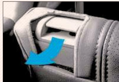
١. مجموعه کلید تنظیم زاویه پشتی صندلی را به جهت بالا کشیده و پشتی صندلی را به سمت بالا ببرید تا در موقعیت صحیح قرار گیرد، سپس کلید را رها کنید.
