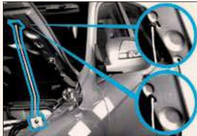
۳. میله نگهدارنده را در سوراخ تعییه شده (مطابق تصویر) داخل درب موتور جا زده و درب موتور را باز نمایید.
