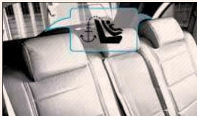
در صورتی که صندلی اینمی کودک دارای تسمه اتصال بالایی می‌باشد، باید تسمه اتصال بالایی را به قلاب نگهدارنده در پشت پشتی صندلی‌های عقب (مطابق تصویر) سوار کنید. برای اطلاع از جزئیات بیشتر، دستور العمل همراه صندلی را مطالعه نمایید.
