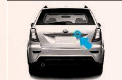
▲ (c) قرار دادن سوئیچ در سیلندر قفل روی درب صندوق عقب و چرخاندن آن در خلاف جهت عقربه های ساعت، درب صندوق عقب را باز می کند.
