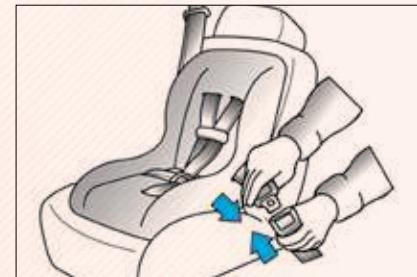
۱. مطابق دستورالعمل کارخانه سازنده، کمربند ایمنی را از داخل یا روی صندلی کودک عبور دهید؛ زبانه را در قفل جا زده و از قفل شدن و پیچ نداشتن تسمه اطمینان حاصل نمایید، بخش روی پای تسمه را سفت کنید.
