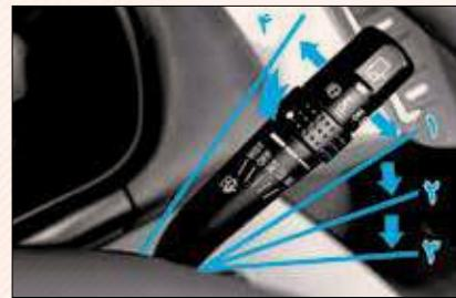
هنگام استفاده از برف پاککن، مطابق تصویر دسته برف پاککن را در موقعیت مورد نیاز قرار دهید. سوئیچ باید در وضعیت روشن "ON" قرار داشته باشد.
