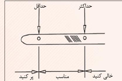
هنگام کار کردن موتور در دمای کاری، موتور را خاموش نموده، سطح روغن را با استفاده از گیج روغن اندازه بگیرید.
