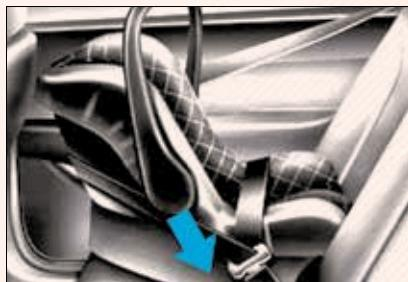
▲ تسمه کمربند ایمنی را مطابق دستورالعمل کارخانه سازنده از داخل یا روی صندلی نوزاد عبور دهید؛ زبانه را در قفل جا زده و از پیچ نداشتن کمربند ایمنی اطمینان حاصل نمایید. بخش روی پای کمربند را سفت کنید.
