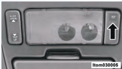
کلید چراغ‌های داخل اتاق
