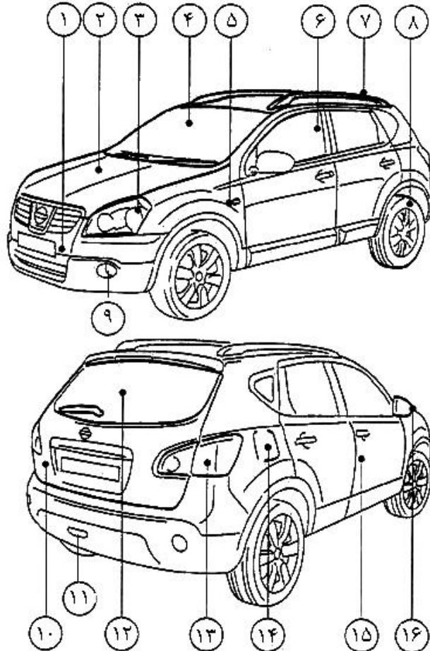
محل قرار گیری نشانگرها و تجهیزات کنترلی (مدل تهویه اتوماتیک)
