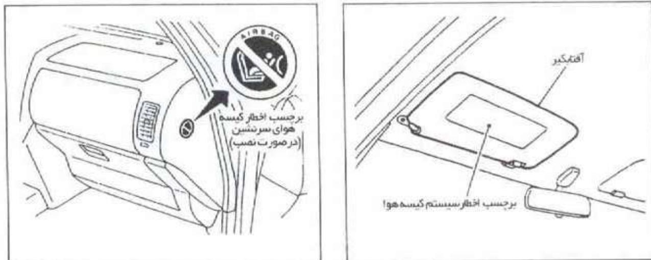
برچسب اخطار سیستم کیسه هوا مطابق شکل
