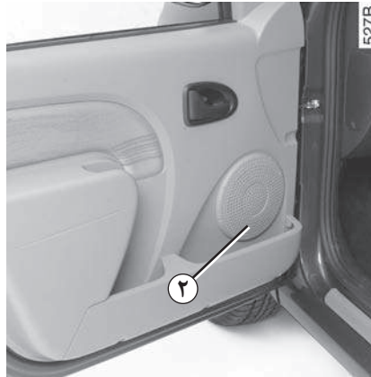
۲ بلندگوهای درب‌های جلو * بر حسب سطح خودرو، توری ۲ را (با کمک یک ابزار ظریف مانند پیچ گوشتی تخت) بردارید.
