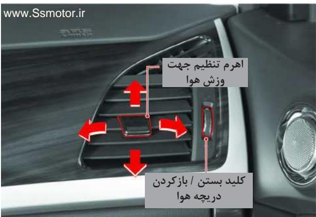
با حرکت دادن اهرم تنظیم جهت جریان هوا بر روی خروجی هوا، می توانید جهت جریان هوا را تنظیم کنید.
