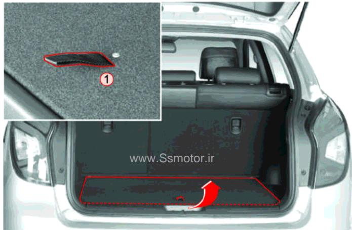
به منظور باز کردن صفحه کفی، محفظه بار عقب نوار (۱) که بر روی صفحه کف پوش قرار دارد به سمت بالا بکشید.
