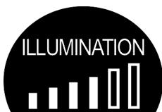
صفحه نمایش LCD ، میزان روشنایی صفحه نمایشگر را در ۶ مرحله نشان می‌دهد. اگر پس از وارد شدن به حالت سطح روشنایی trip/reset فشرده نشود، صفحه نمایش از ۳ ثانیه کلید (illumination level) طی مدت این حالت به حالت دمای محیط بیرون (ambient air temperature) تغییر وضعیت می‌دهد. جهت تنظیم سطح روشنایی صفحه نمایشگر، کلید trip/reset را فشار دهید تا صفحه نمایش LCD سطح روشنایی مورد نظر (۱ to 6) را نمایش دهد.
