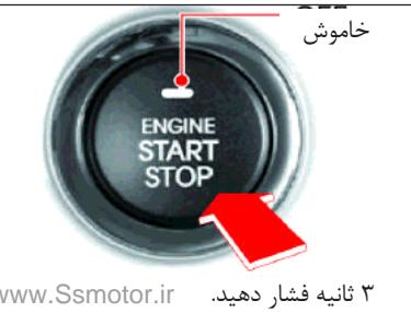
در یک شرایط اضطراری در حالی که خودرو در حال حرکت می باشد، شما می توانید با فشردن دکمه استارت به مدت بیش از ۳ ثانیه، موتور خودرو را خاموش کنید.
