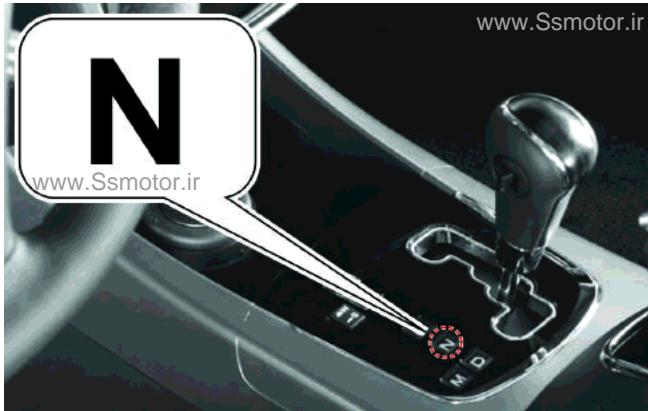
در موقعیت خلاص (N)، هیچ نیرویی منتقل نخواهد شد. دراین موقعیت موتور هیچ نیرویی را به چرخها منتقل نمی کند و خودرو دریک مسیر صاف حرکتی نیز نخواهد داشت. هرچندکه به منظور رعایت نکات ایمنی، درصورت قرار داشتن اهرم تعویض دنده در موقعیت N، از ترمز استفاده نمایید. پس از توقف خودرو، دنده را از موقعیت N به موقعیت D یا R قرار داده و پدال ترمز را فشار دهید.
