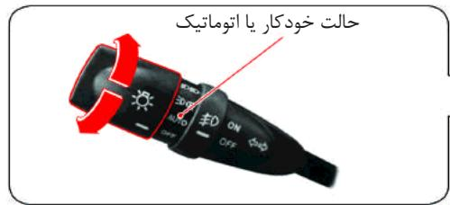
سنسور نور، شدت روشنایی محیط را حس کرده و براین اساس، زمان روشن و خاموش شدن خودکار چراغهای جلو و عقب را در هنگامی که اهرم چراغ در وضعیت خودکار قرار دارد تعیین خواهد نمود.
