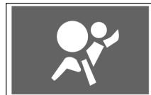
نشانگر خاموش بودن کیسه هوا سرنشین جلو این نشانگر پس از چرخش کلید ON/OFF کیسه هوا سرنشین جلو و قرار دادن آن در موقعیت «OFF» این کیسه هوا غیرفعال خواهد شد.
