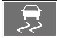
در صورت قرار دادن کلید استارت در موقعیت روشن (ON)، این چراغ هشدار روشن شده و پس از چند ثانیه خاموش می‌گردد.
