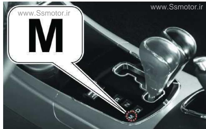
پس از قرار دادن اهرم تعویض دنده از موقعیت D به M، از طریق دکمه روی اهرم دنده اقدام به تعویض دنده کنید.
