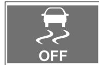
در صورت فشار دادن کلید استارت (قرار دادن کلید در حالت روشن)، این چراغ هشدار روشن شده و با روشن شدن موتور، این چراغ خاموش می‌شود.
