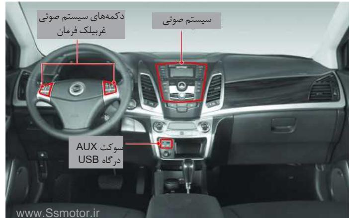
برای گوش دادن به موسیقی می‌توانید از سیستم صوتی، سوکت AUX و درگاه USB استفاده کنید.
