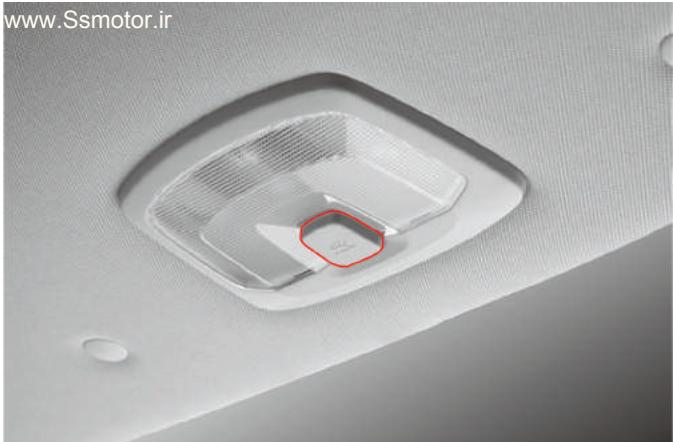
در صورت فشرده شدن کلید چراغ و باز و بستن درب محفظه بار عقب، چراغ محفظه بار خاموش و روشن می شود (عملکرد وابسته درب و چراغ های داخل اتاق)
