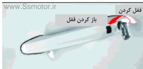
۶. به منظور قفل کردن درب‌ها، کلید را در جهت صحیح قفل شدن بچرخانید، هر چند که دزدگیر نمی‌تواند فعال باشد.
