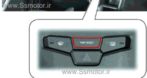
کلید سیستم مدیریت پیماش و تنظیم مجدد آن
