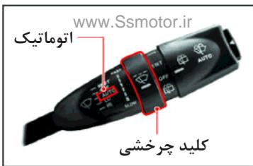
سرعت برف پاک کن در حالت خودکار (AUTO) (قرار دارد، به سیله کلید چرخشی نشان داده شده در عکس فوق قابل تنظیم می باشد).
