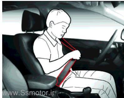
۴. تسمه را بکشید تا از قفل شدن آن اطمینان حاصل کنید. در صورت شل بودن تسمه، حفظ جان سرنشین به مقدار قابل توجهی کاهش می‌یابد.
