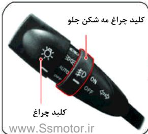
این کلید برای روشن و خاموش کردن (چراغ های جلو، عقب، موقعیت کوچک)، پلاک راهنمایی و رانندگی، راهنمایی و مه شکن به کار می رود.
