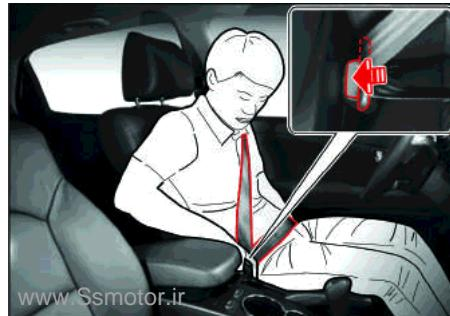
۲. تسمه روی شانه را از روی بدن عبور داده و تسمه روی لگن را تا حد ممکن پایین تر از لگن قرار دهید. سپس زبانه تسمه را به قفل وارد کرده و جا بزنید.
