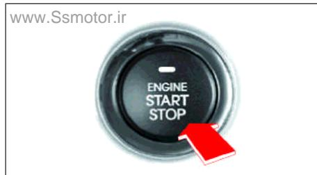
۵. با فشار دادن پدال ترمز و دکمه استارت موتور به همراه قرار دادن اهرم تعویض دنده در موقعیت پارک (P) یا خلاص (N) اقدام به روشن کردن موتور نمایید.
