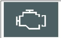
در صورت روشن بودن کلید استارت، این چراغ هشدار روشن و با روشن شدن موتور، این چراغ هشدار را در حین رانندگی روشن شده و یا روشن بماند، این امر حاکی از بروز اشکال در برخی اجزای کنترلی موتور شامل سنسورها و تجهیزات می باشد.
