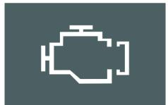
وقتی که سیستم‌های برقی اصلی و یا سوخت موتور به طور صحیح کار نکنند، چراغ چک موتور که در صفحه پشت آمپر قرار دارد روشن خواهد شد. در نتیجه ممکن است توان موتور کاهش یابد و موتور از کار بیافتد. در صورت بروز چنین مشکلی حتماً به یکی از عاملیت‌های مجاز رامک یدک مراجعه فرمایید.
