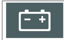
پس از روشن شدن کلید استارت (قراردادن کلید در حالت روشن)، این چراغ هشدار روشن شده و با روشن شدن موتور، این چراغ خاموش می شود. در صورتیکه پس از روشن کردن موتور، این چراغ هشدار خاموش نشود و در حین رانندگی روشن شود، این حالت نشان دهنده بروز نقص در سیستم می باشد. در این شرایط برای بررسی سیستم حتماً به عاملیت مجاز رامک یدک مراجعه کنید.
