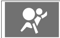
در صورت روشن شدن کلید استارت و یا قرار گرفتن کلید در حالت روشن، این چراغ هشدار روشن شده و سپس خاموش می شود در این حالت از عملکرد صحیح کیسه هوا مطمئن شوید. در صورت روشن و یا خاموش نشدن چراغ هشدار کیسه هوا، یا چشمک زدن یا روشن باقی ماندن این چراغ در حین رانندگی، وجود نقص در سیستم محزز می گردد. بلا فاصله سیستم کیسه هوا را با مراجعه به عاملیت مجاز رامک یدک مورد تحت بررسی و بازدید فنی قرار دهید.
