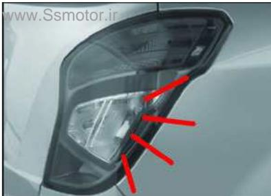
در صورت قفل شدن تمامی درب ها، فلاشرهای دو بار چشمک زده و صدای آژیر یکبار شنیده می شود، یعنی اینکه سیستم دزدگیر در حالت فعال قرار دارد.
