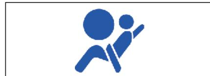
اگر موقع فشردن سوئیچ موتور به وضعیت "ON" چراغ ایربگ بر صفحه نمایشگر (جلو آمپر) چشمک نزند یا روشن نشود، یا چراغ ایربگ روشن بماند، یا موقع رانندگی روشن شود، ممکن است سیستم ایربگ (یا سیستم پیش کشنده کمربند ایمنی) خراب باشند. در اولین فرصت ممکن برای بازرگانی سیستم ایربگ به نمایندگی های مجاز منتخب سوزوکی کیزاشی\* مراجعه نمایید.
