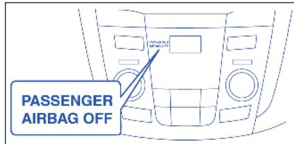
اگر می خواهید که صندلی کودک را بر صندلی سرنشین جلو نصب نمایید کیسه هوا سرنشین جلو باید غیرفعال شود. موقعی که کلید موتور را برای تغییر حالت احتراق به "ON" فشار می دهید، نشانگر "خاموش شدن کیسه هوا سرنشین" "PASSENGER AIR BAG OFF" نشان می دهد که آیا کیسه هوا سرنشین جلو فعال یا غیرفعال است.
