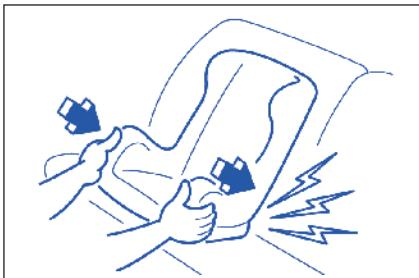
۶) قسمت جلوی نگهدارنده کودک را گرفته و نگهدارنده را با زور فشار دهید تا به میله های اتصال چفت شود. با حرکت دادن سیستم نگهدارنده کودک به تمام جهات و مخصوصاً به سمت جلو، اطمینان حاصل نمایید که سیستم نگهدارنده کودک به طور محکم چفت شده است.
