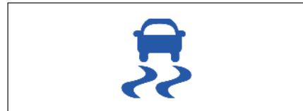
موقعی که یکی از سیستم های **ESP** غیر از ABS فعال می شود این چراغ ۵ بار در ثانیه چشمک می زند. اگر این چراغ چشمک زند، با دقت رانندگی کنید.
