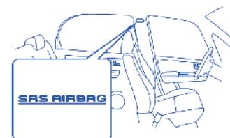
ایربگهای جانبی پرده ای در آستر سقف قرار گرفته اند. واژه "SRS AIRBAG" بر ستون حک شده است تا نشانگر محل ایربگ جانبی پرده ای باشد.
