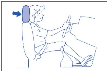
پشت سری به منظور کمک به کاهش صدمات واردہ به گردن در تصادفات طراحی شده است. پشت سری صندلی را طوری تنظیم نمایید که مرکز آن نزدیک با بالای گوش شما قرار بگیرد. اگر این کار برای سرننشینان بسیار قدبند امکان پذیر نباشد، آنرا در بالاترین وضعیت خود تنظیم نمایید.
