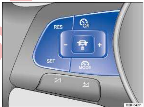
تصویر 130 سمت چپ فرمان چندمنظوره: دکمه‌های استفاده از ACC.
