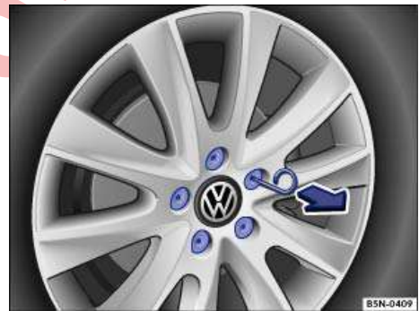
تصویر 223 باز کردن درپوش پیچ‌های چرخ.
