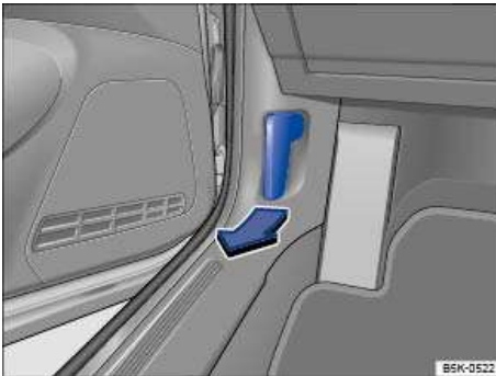
تصویر 203 در محل استقرار پای راننده: اهرم آزاد کننده درب محفظه موتور.
