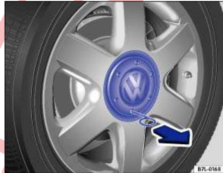
تصویر 220 باز کردن درپوش مرکزی چرخ با کشیدن.
