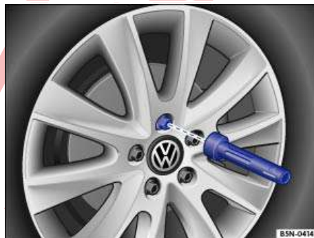
تصویر 230 تعویض چرخ: پیچ‌های چرخ را با استفاده از آچار چرخ باز کنید.
