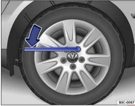
تصویر 224 تعویض چرخ: باز کردن پیچ‌های چرخ.
