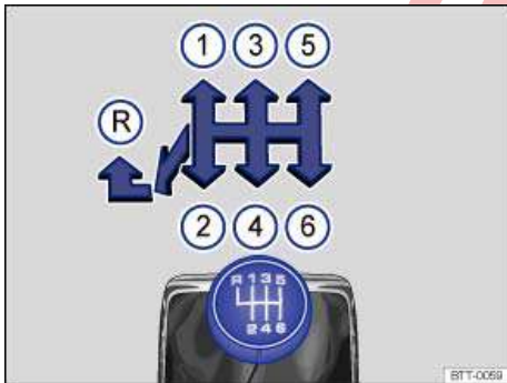
تصویر 116 الگوی تعویض دنده در گیربکس 6 دنده‌ای.
