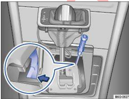
تصویر 154 باز کردن اضطراری قفل دسته دنده (نوع 1).
