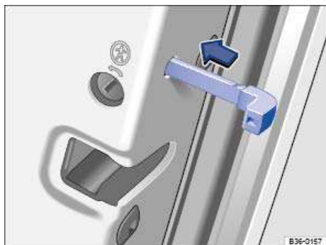
تصویر 87 روی قسمت انتهایی درب سمت راست: قفل کردن اضطراری خودرو با کلید یدکی.
