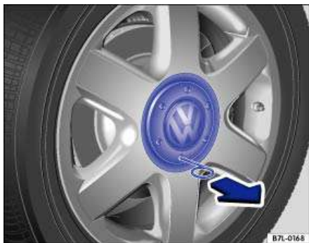
تصویر 314 باز کردن درپوش مرکزی چرخ با کشیدن.
