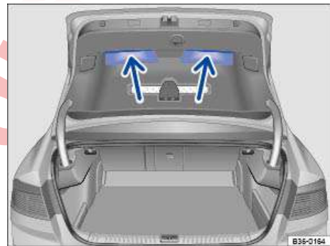
تصویر 92 درب صندوق عقب باز: دستگیره برای کشیدن (لیموزین).
