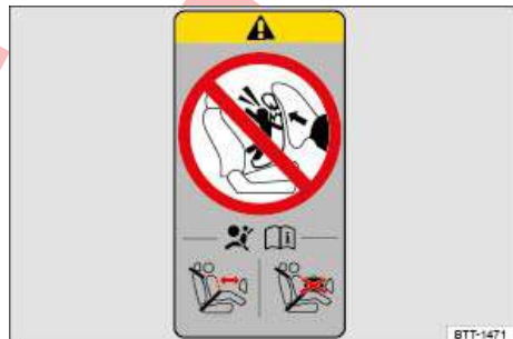
تصویر 26 طرح کلی: برجسب کیسه هوا روی ستون میانی خودرو (ستون B).
