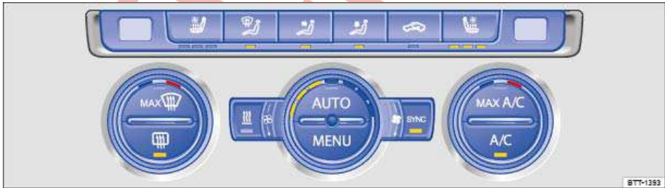
تصویر 133 در قسمت فوقانی کنسول مرکزی: کنترل‌های سیستم کلابمترونیک.
