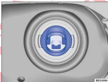
تصویر 267 تصویر: دستگاه جلوگیری از سوختگیری نامناسب در گردن باک.
