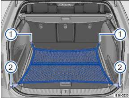
تصویر 250 در صندوق عقب: تور نگهدارنده نصب شده مستقیم.
