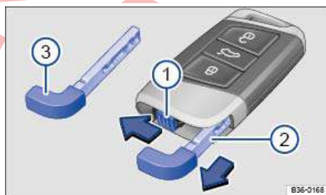
تصویر 75 کلید خودرو: آزاد کردن کلید بدکی.
