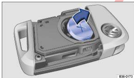
تصویر 74 کلید خودرو: تعویض باتری دکمه‌ای.
