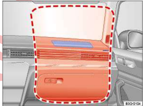
تصویر 16 محل نصب و محدوده عملکرد کیسه هوای جلوی سرنشین کنار راننده.
