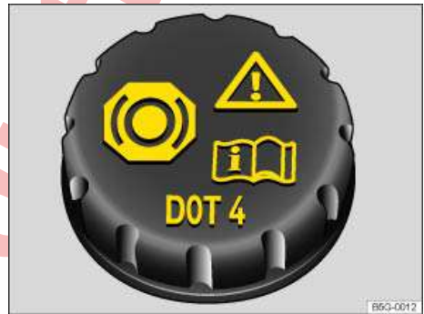
تصویر 303 در محفظه موتور: درب محفظه روغن ترمز.
