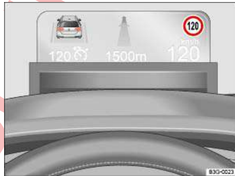
تصویر 58 در صفحه داشبورد قسمت بالای فرمان: نمونه نمایش در نمایشگر فرانما.
