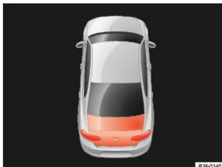
تصویر 89 در نمایشگر مجموعه ابزارهای ترکیبی: درب صندوق عقب باز است یا به درستی بسته نشده است (لیموزین).
