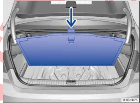
تصویر 232 در صندوق عقب: کفی صندوق عقب نصب شده.
