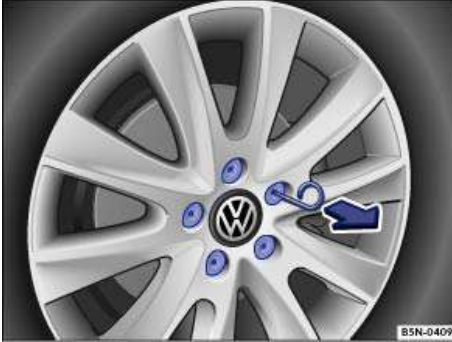
تصویر 317 باز کردن درپوش پیچ‌های چرخ.
