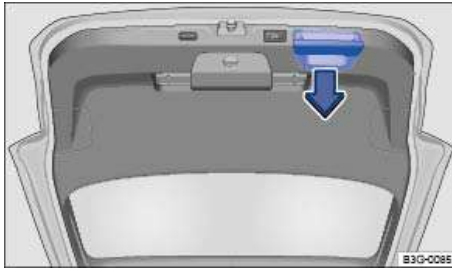
تصویر 93 درب صندوق عقب باز: دستگیره برای کشیدن (استیشن).
