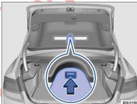
تصویر 36 در درب صندوق عقب: پایه نگهدارنده مثلث خطر (ایموزین).
