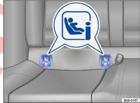
تصویر 27 روی صندلی خودرو: علامت حلقه‌های مهارکننده ISOFIX برای صندلی‌های کودک.
