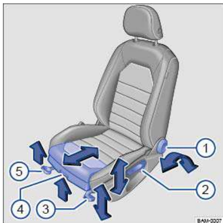
تصویر 103 اجزاء کنترل در صندلی جلوی سمت چپ (نوع 2).
