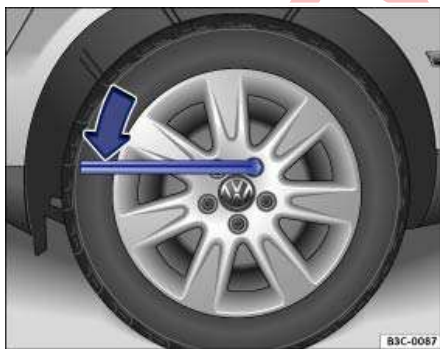
تصویر 318 تعویض چرخ: باز کردن پیچ‌های چرخ.
