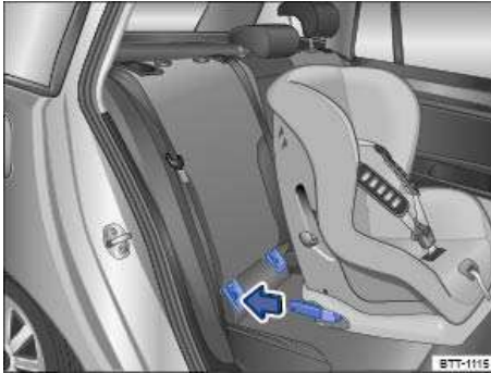
تصویر 28 طرح کلی: نصب صندلی ISOFIX با دسته‌های اتصال.
