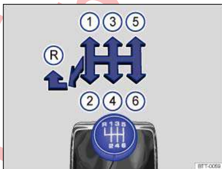
تصویر 136 الگوی تعویض دنده در گیربکس 6 دنده‌ای.
