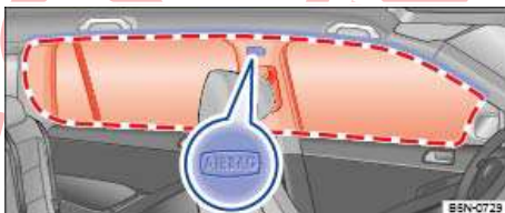
تصویر 20 سمت چپ خودرو: محل نصب و محدوده عملکرد کیسه هوای سر.
