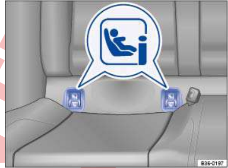
تصویر 26 روی صندلی خودرو: علامت حلقه‌های مهارکننده ISOFIX برای صندلی‌های کودک.
