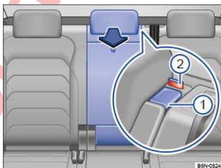
تصویر 225 در پشتی صندلی عقب: باز کردن دریچه دسترسی به صندوق عقب.
