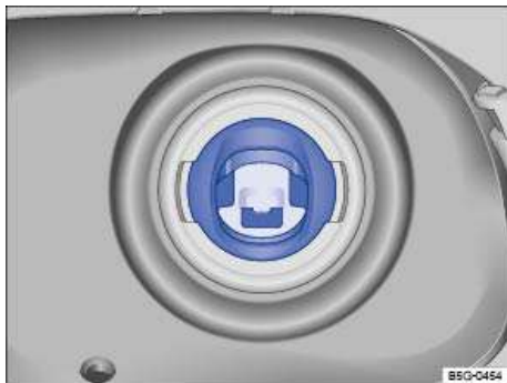
تصویر 232 تصویر: دستگاه جلوگیری از سوخت‌گیری نامناسب در گردن باک.
