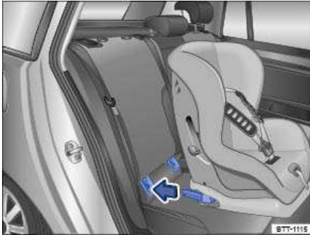
تصویر 27 طرح کلی: نصب صندلی ISOFIX با دسته‌های اتصال.
