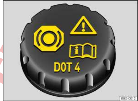
تصویر 267 در محفظه موتور: درب محفظه روغن ترمز.
