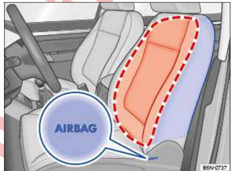
تصویر 19 جنب صندلی جلو: محل نصب و محدوده عملکرد کیسه هوای جانبی.
