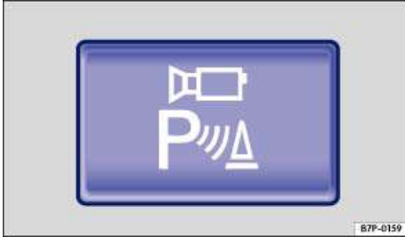
تصویر 177 در کنسول وسط: دکمه برای خاموش و روشن کردن سیستم راهنمای پارک ParkPilot (بسته به تجهیزات خودرو).
